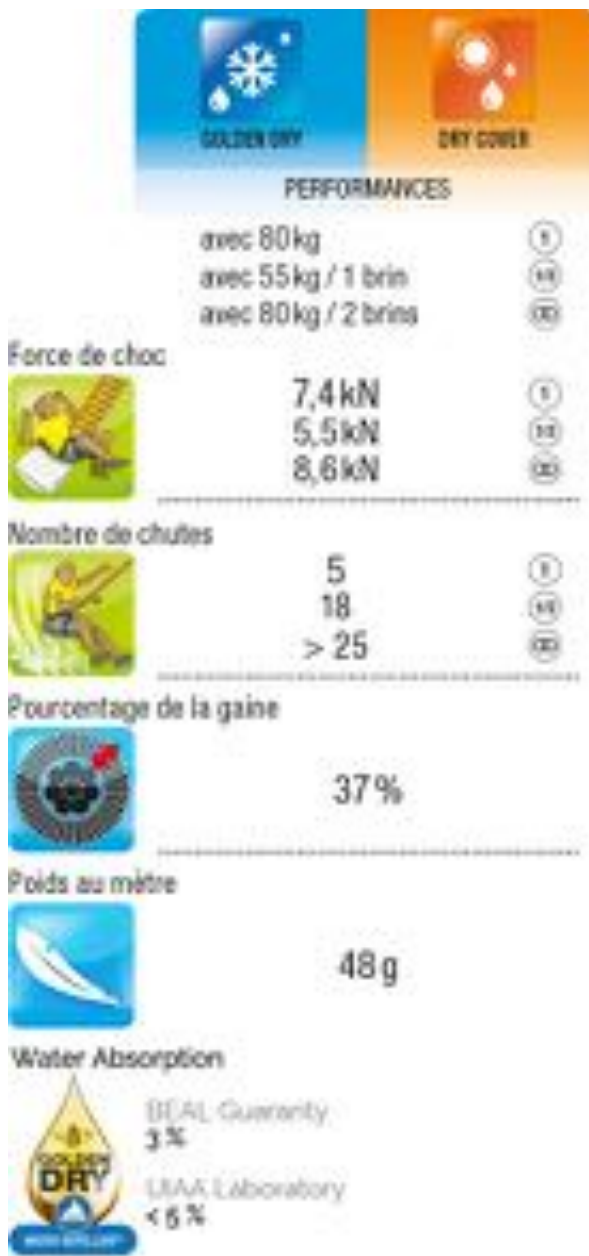
Caractéristiques de la corde multi-normes BEAL Opera
